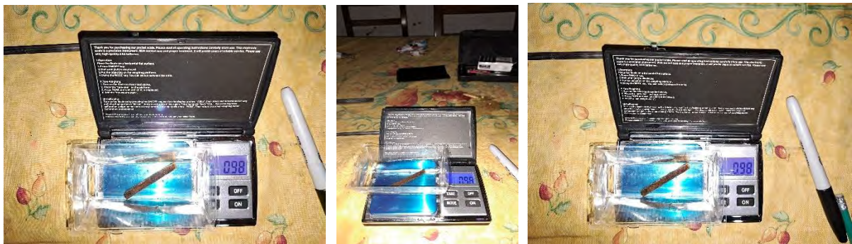
Fig.5 : Mesure du volume des carottes suivant la méthode par déplacement d'eau
